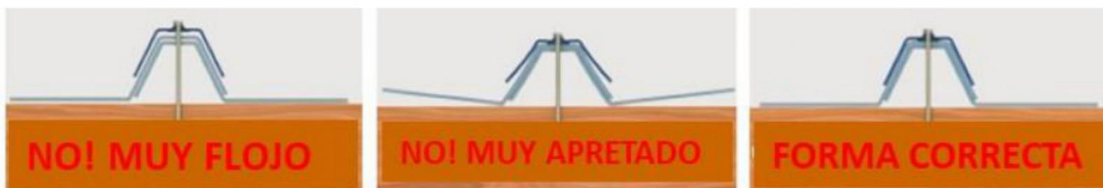
El tornillo de rosca debe fijarse solo por encima de la correa. Si el tornillo se fija en la posición sin correa, podría romper la hoja. Sugerir 4 juegos de tornillos por metro cuadrado, si es zona de alto viento fijar 6 conjuntos de tornillos por metro cuadrado.
